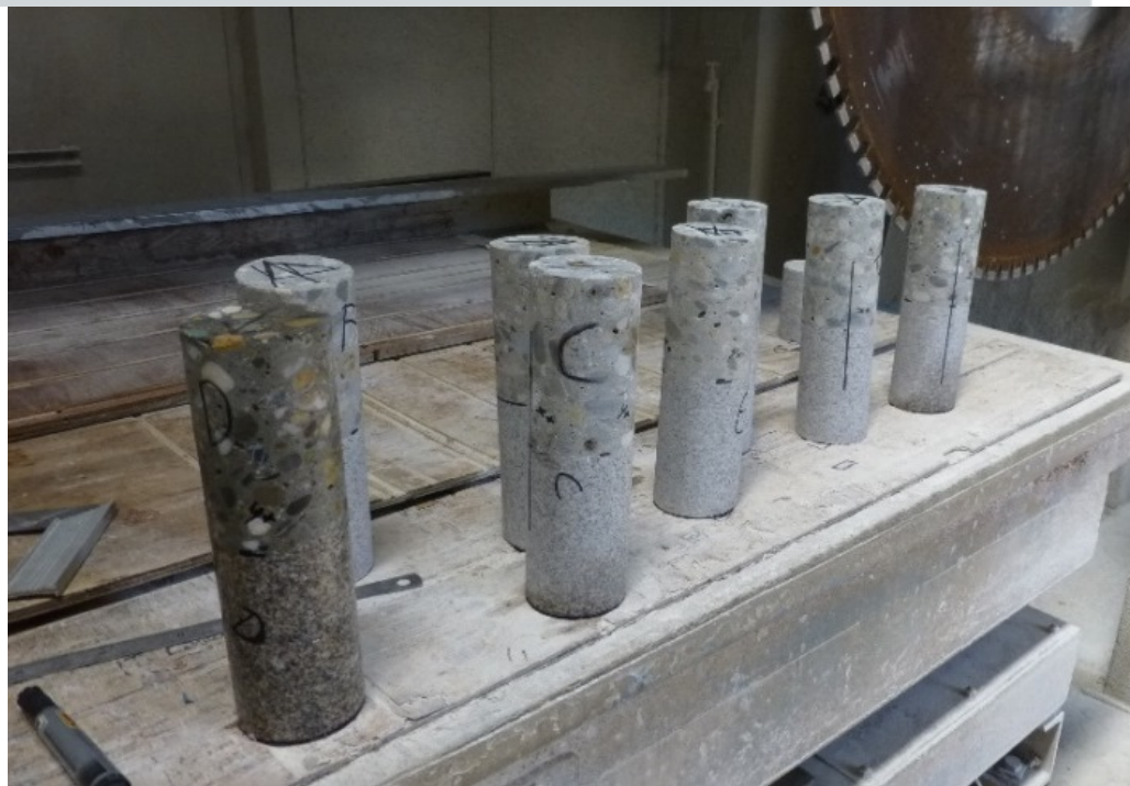
Photographie des huit carottes béton – roche après surfacage des extrémités (NF XP P94-424) (plan moyen parallèle et à mi-distance des extrémités)
