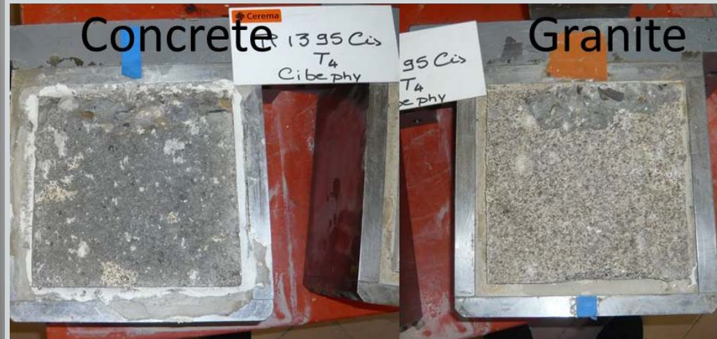
Exemple d'état des surfaces après rupture (Essai T4)
