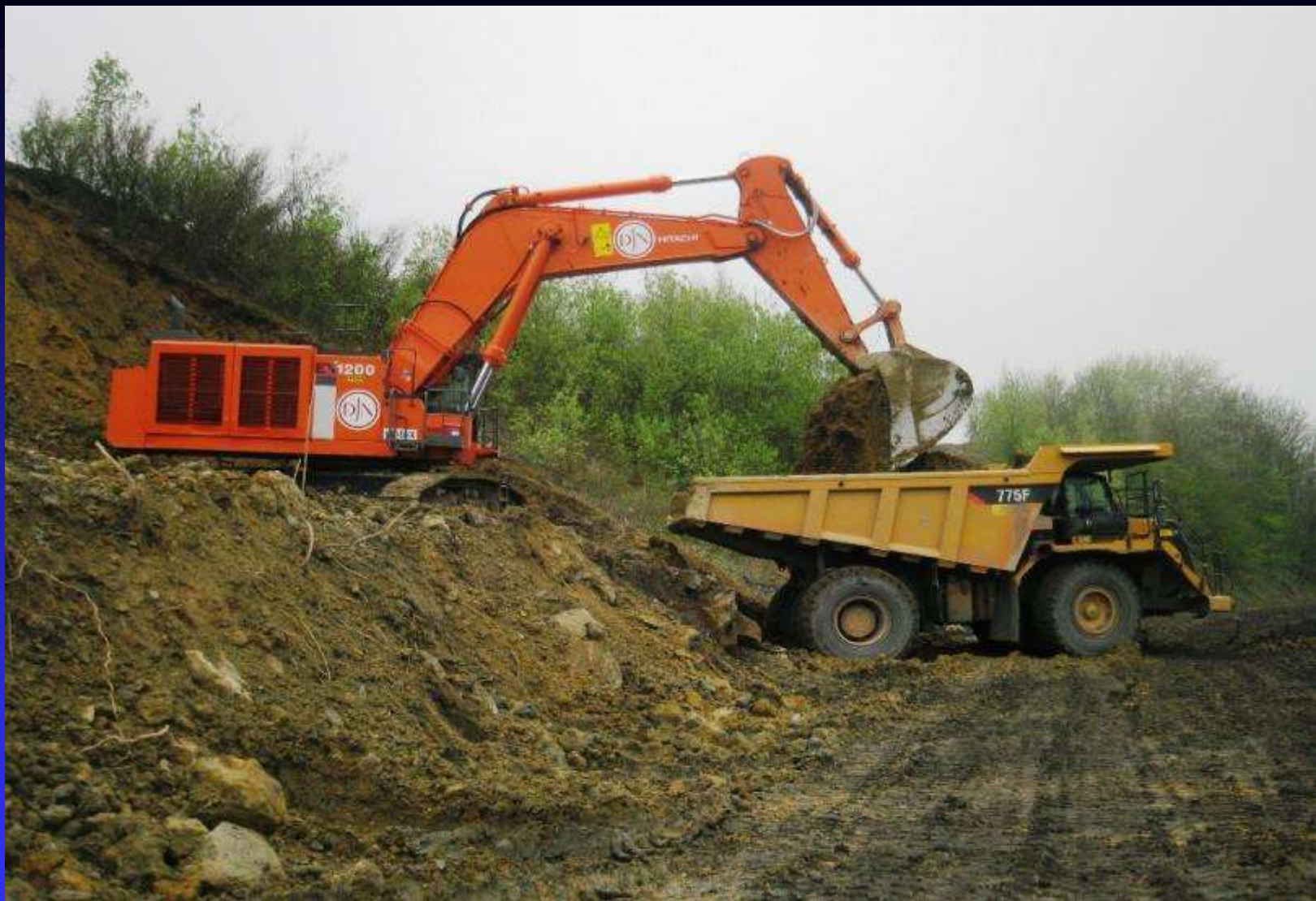
Pelle en rétro de 120T (7m 3 ) chargeant un dumper rigide de 65 T
