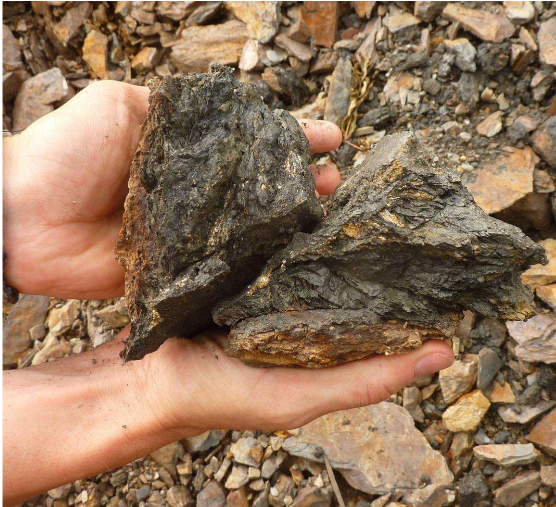
Fig. 3B. Fragment de schiste broyé tectoniquement et extrait d'une des très nombreuses zones écrasées du talus. Le matériau est formé de petits fragments de schistes de dimensions diverses et imbriqués les uns dans les autres. La roche est de ce fait peu perméable et l'altération profonde (transformation en schiste brun) y progresse seulement lentement. La roche est cependant peu consolidée et à l'air libre elle se dégrade mécaniquement, sous l'action des agents météorologiques (eau, glace et changement de température) très rapidement en roche meuble (SGL 12-07-2010).
