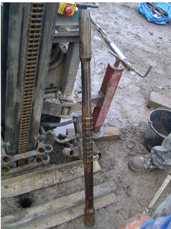
3) Sonde picométrique nettoyée avant la réalisation de l'essai picométrique
