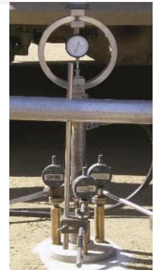
Essai à la plaque « belge » (détermination du module M1)
