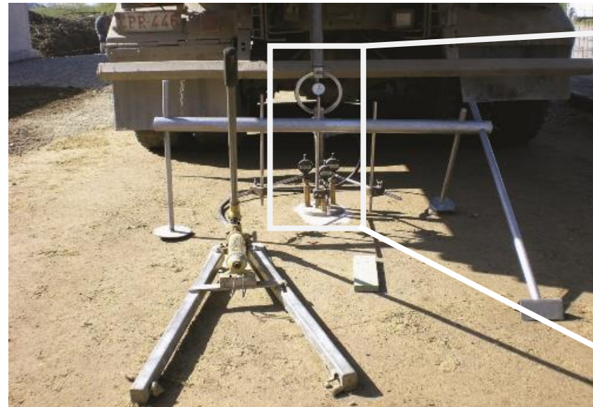
Essai à la plaque « belge » (détermination du module M1)
